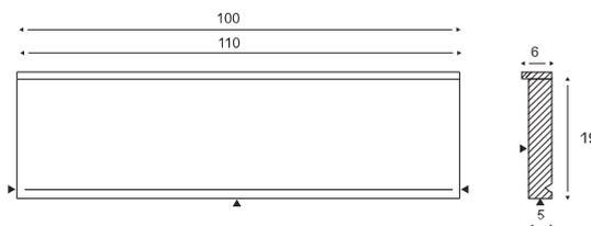
Flach mit aufgeklebter Oberseite, gerade und kantig, Tropfrille von 0,6cm x 0,6cm 2cm von Vorderseite, stoppt 2cm von bearbeiteten Kopfpen.
