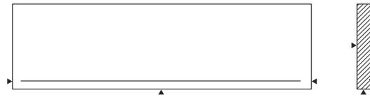
Flache Schwelle, gerade und quadratisch, Tropfrille von 0,6 cm x 0,6 cm 2 cm von vorne, Anschläge 2 cm von den bearbeiteten Köpfen. Wird nach den angegebenen Maßen angefertigt.
