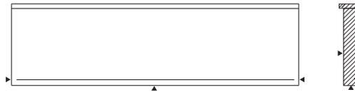
Flache Schwelle mit aufgeklebter Aufkantung, gerade und rechteckig, Tropfrille von 0,6 cm x 0,6 cm 2 cm von der Vorderseite, Anschlag 2 cm vom bearbeiteten Kopfpen.
