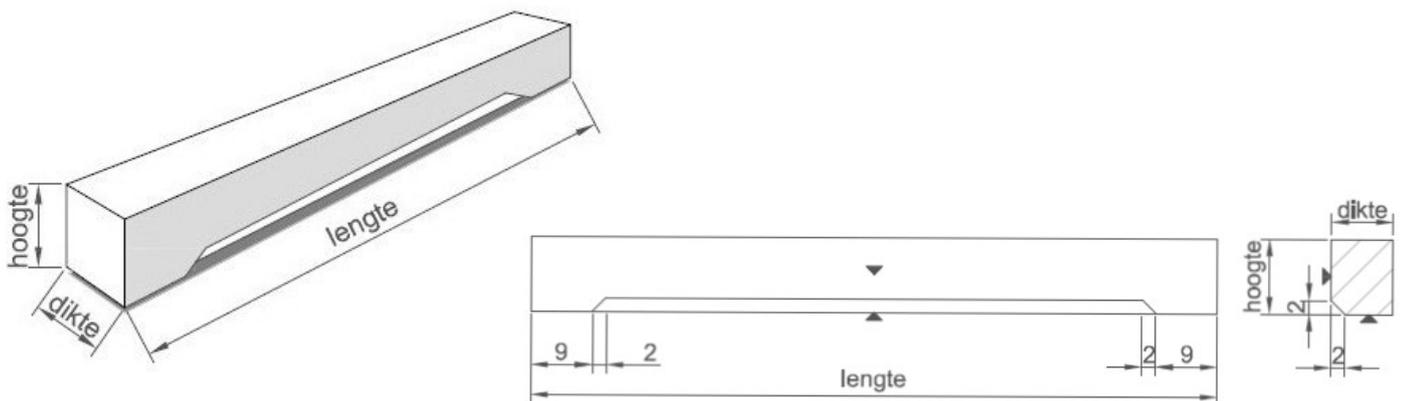
Fenstersturz, gerade und rechteckig, mit einer abgewinkelten Vorderseite. Wird nach vorgegebenen Maßen gefertigt.
