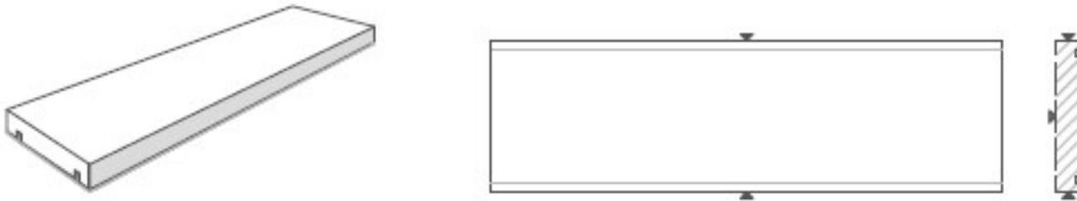
Flacher Deckstein, gerade und quadratisch, 2 x Tropfrille von 0,6 cm x 0,6 cm 2 cm von der Vorderseite, stoppt 2 cm vom gefrästen Kopfpen. Wird nach den angegebenen Maßen angefertigt. Länge > 180 cm wird in mehreren Stücken ausgeführt.
