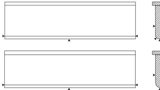
Flache Garagentürschwelle mit abgerundeter oder abgeschrägter Ecke 2 x 2 cm mit aufgeklebter Aufkantung, flach, gerade und quadratisch, ohne Tropfrille. Wird nach den angegebenen Maßen geliefert.
