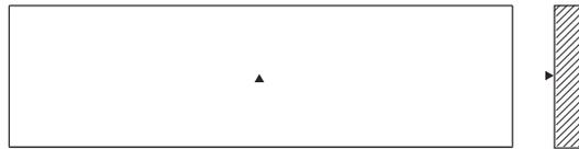
Fassadensockel flach, gerade und quadratisch. Wird nach den angegebenen Maßen geliefert. Längen > 180 cm werden in mehreren Stücken hergestellt.
