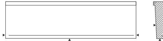
**Massive Ausführung**, abtropfend, gerade und quadratisch, Tropfrille von 0,6 cm x 0,6 cm 2 cm von der Vorderseite, stoppt 2 cm vom bearbeiteten Kopf.
