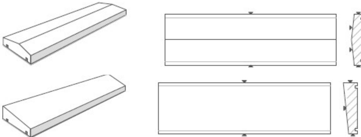
Drainageabdeckstein, gerade und senkrecht, 2 x Tropfrille von 0,6 cm x 0,6 cm, 2 cm von Vorderseite, stoppt 2 cm von bearbeiteten Köpfpen. Wird nach den angegebenen Maßen angefertigt. Länge > 180 cm wird in mehreren Stücken ausgeführt.
