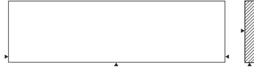
Flache, gerade und rechtwinklige Treppenstufe. Wird in den angegebenen Abmessungen geliefert. Längen > 180 cm werden in mehreren Stücken hergestellt.
