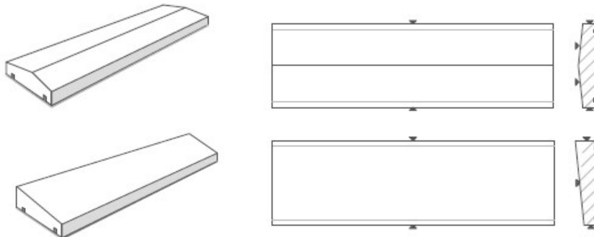
Entwässernde Deckstein, gerade und senkrecht, 2 x Tropfnase von 0,6 cm x 0,6 cm 2 cm von der Vorderseite, Stopps 2 cm von den bearbeiteten Köpfen. Wird nach den angegebenen Maßen angefertigt. Längen > 180 cm werden in mehreren Stücken ausgeführt.
