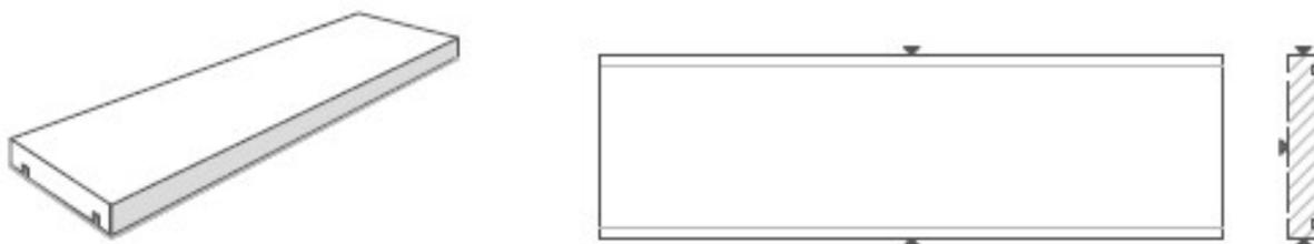
Flacher Abdeckstein, geradlinig und quadratisch, 2 x Tropfrille von 0,6 cm x 0,6 cm 2 cm von der Vorderseite, Anschläge 2 cm von den bearbeiteten Köpfen. Wird nach den angegebenen Maßen angefertigt. Längen > 180 cm werden in mehreren Stücken ausgeführt.
