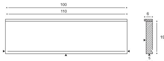
Flach mit aufgeklebter Kante, geradlinig und quadratisch, Tropfrille von 0,6 cm x 0,6 cm 2 cm von der Vorderseite, Anschläge 2 cm von bearbeiteten Köpfen.
