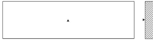
Sockelleiste flach, gerade und quadratisch. Wird nach den angegebenen Maßen geliefert. Längen > 180 cm werden in mehreren Stücken hergestellt.
