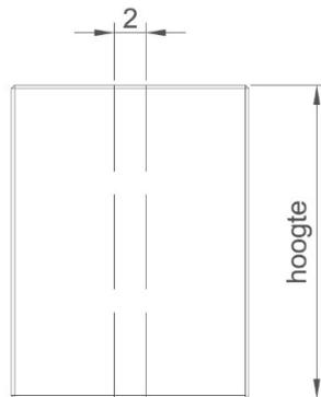
Sockel mit Facettenschliff, Blau (Blauer Blaustein) oder Grau geschliffen (Vinalmont). Durchgeführt mit einem zentralen Bohrloch Durchmesser 20 mm.
