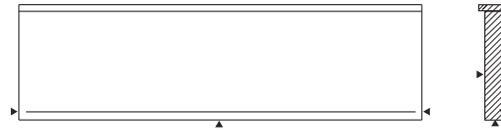
Flache Schwelle mit aufgeklebter Aufkantung, geradlinig und kantig, Tropfrille von 0,6 cm x 0,6 cm 2 cm von der Vorderseite, Anschläge 2 cm von bearbeiteten Köpfen.
